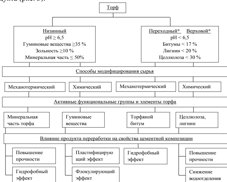
Рисунок 3 Классификация торфяного сырья применительно к получению модифицирующих добавок для цементных систем
