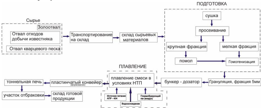
Рисунок 6 – Технологическая схема производства облицовочных строительных стеклокристаллических материалов, полученных с использованием низкотемпературной плазмы
