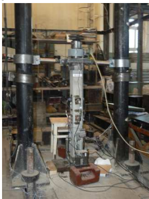
Рисунок 4 – Стенды для испытания железобетонных колонн и их стыков на статическую (а) и кратковременную динамическую (б) нагрузку
