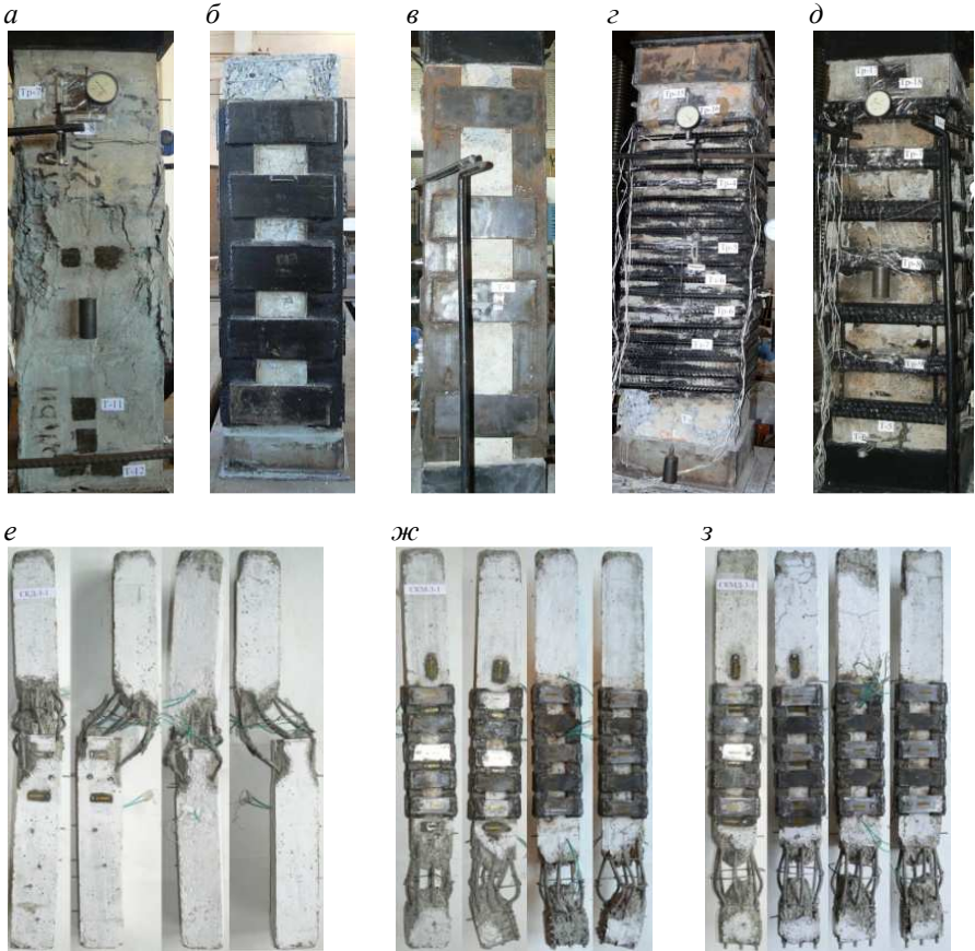
Рисунок 6 – Схемы разрушения экспериментальных образцов при действии статической ( a – образец СК-1; б – образец СКМ-1; в – образец СКМ-2; г – образец СКМ-3; д – образец СКМ-4-1) и кратковременной динамической ( e – образец СКД д -3-1; ж – образец СКМ д -3-1; з – образец СКМД д -3-1) нагрузок
