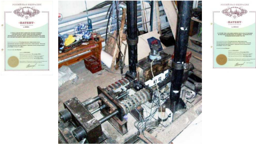
Рис. 3. Общий вид испытания сжатых железобетонных элементов на поперечные кратковременные динамические нагрузки
