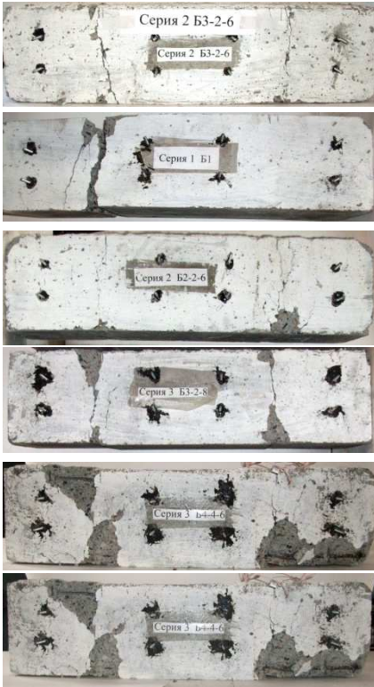
Рис. 4. Экспериментальные и численные исследования сжатых бетонных и железобетонных элементов при поперечной нагрузке: а – характерное разрушение бетонных и железобетонных элементов при динамическом нагружении; б, в - результаты расчетов в ВК «Лира» железобетонных образцов с обжатием 0,25R_b b h с арматурой 2 \text{ } \varnothing 6 \text{ A400 (A-III)} , расположенной горизонтально (б) или расположенной вертикально (в)
